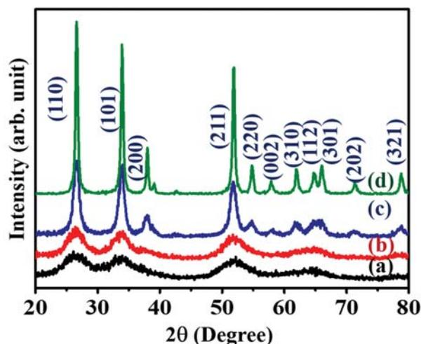
Figure 2.1 XRD of samples (a) A (100 °C), (b) B (300 °C), (c) C (500 °C), and (d) D (800 °C)
